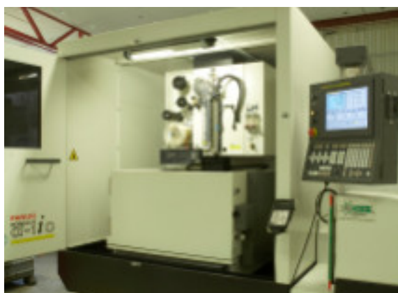
Trådnist Fanuc Robocut 650 mm x 450 mm x 180 mm.
