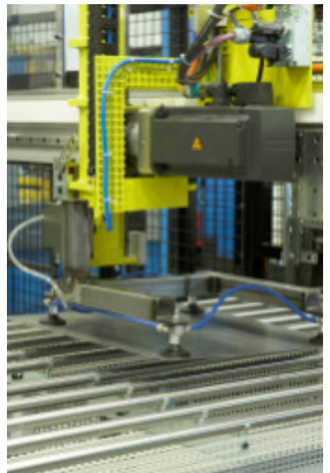
AP&T Pressline 3 x 6 300 kN. Hydraulpress betjänad med CD robotar.
